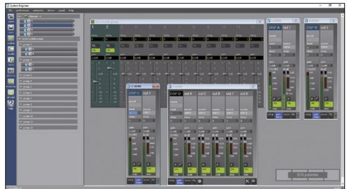
Les modules sont ici groupés par deux et donc pilotables en simultanément, au niveau des gains et de l'égalisation, une fonctionnalité intéressante de System Engineer.
