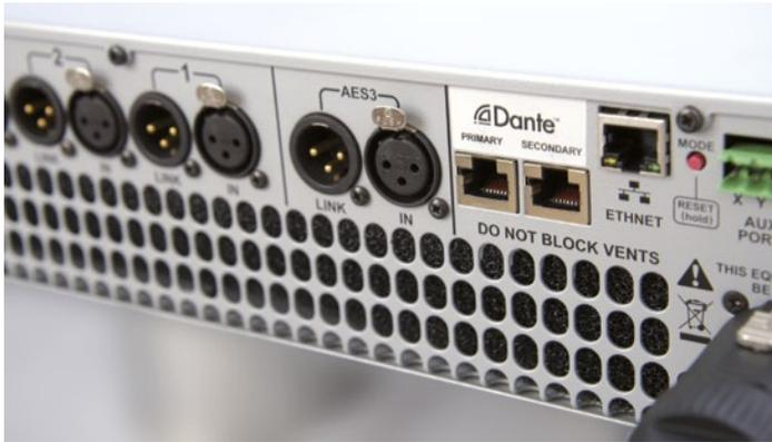
Une vue de détail de la face arrière, avec les entrées Dante et les entrées AES3. On devine en bas à droite le gros connecteur secteur Powercon 32A.
