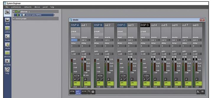
Le logiciel System Engineer sous Windows 10, avec la liste des amplis connectés par le réseau à gauche, et le panneau de contrôle principal dudit ampli. On y retrouve les fonctions et indicateurs essentiels.
