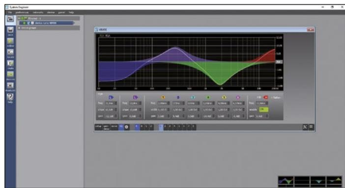
La page EQ pour une voie d'entrée : l'égalisation peut être paramétrée à la souris ou par les valeurs numériques pour chaque canal. A noter en bas à droite, la palette de filtres (EQ palette) qui permet de rappeler instantanément un filtrage par un simple glisser-déposer. Astucieux.
