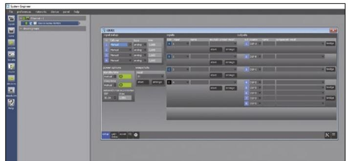
L'écran de configuration des entrées et le routage des différents modules, suivant le concept cher à Linea Research. Notons la présence de fonctionnalités de gestion de l'alimentation (Power Options), avec mise en veille automatique après un certain temps d'inactivité. Un bon point pour les économies d'énergie.
