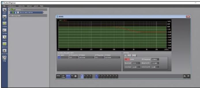
Le limiteur en mode VX, une spécificité Linea Research, un compresseur à deux bandes conçu lorsque l'ampli attaque une enceinte deux voies à filtre passif. L'action du limiteur aigu est indiquée en rouge sur le graphe.
